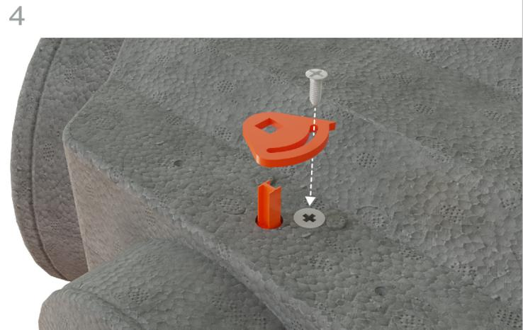
Dans le cas d'un volet manuel vissez d'abord une cheville en nylon puis insérer le palier de guidage manuel et enfin la vis de serrage.
