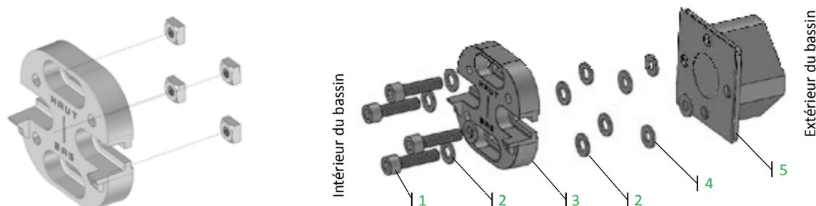
Figure 37 – Montage de la bride porte-palier
