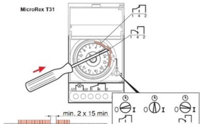
Figure 58 – Programmation automatique de la filtration
