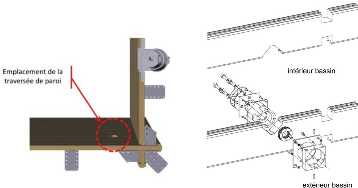
Figure 26 – Emplacement de la traversée de paroi
