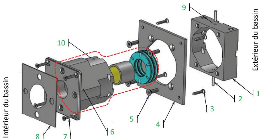
Figure 27 – Montage de la traversée de paroi
