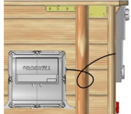
**!** Il est impératif de connecter le fil marron à la borne + et le fil bleu à la borne -. Une erreur de câblage aboutirait à une rotation du moteur en sens inverse et par conséquent à de graves dommages pour la couverture automatique.
