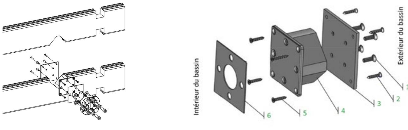
Figure 28 – Montage du support de palier
