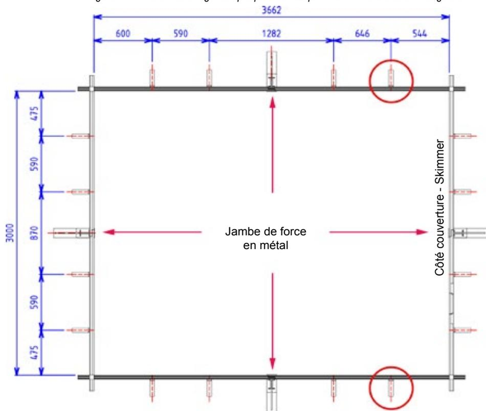
Figure 15 – Emplacement des consoles de margelles
