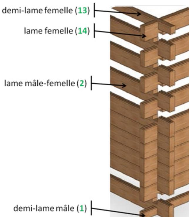
Figure 9 – Principe d'emboîtement des lames de bois
