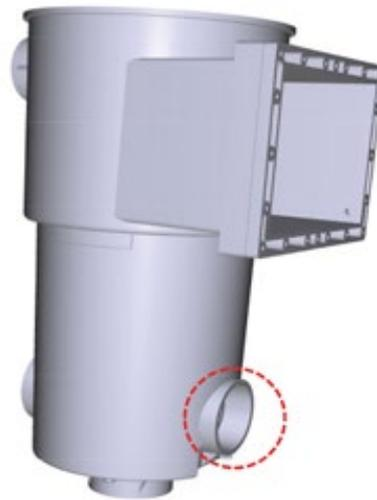
Figure 22 – Montage de la cale sur le skimmer
