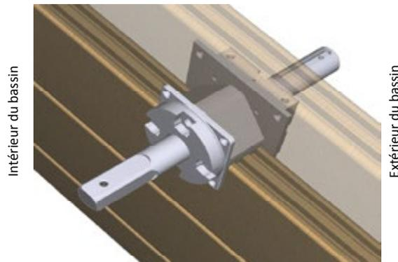
Figure 39 – Montage de l'arbre de couverture automatique
