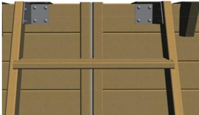
Figure 17 – fixation de l'escalier extérieur sur le bassin
