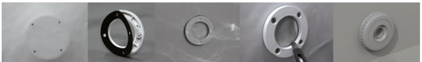
Figure 35 – Montage de la bride sur le refoulement
