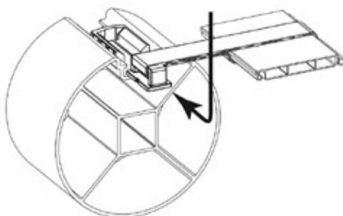
Figure 45 – Jonction du tablier et de l'axe
