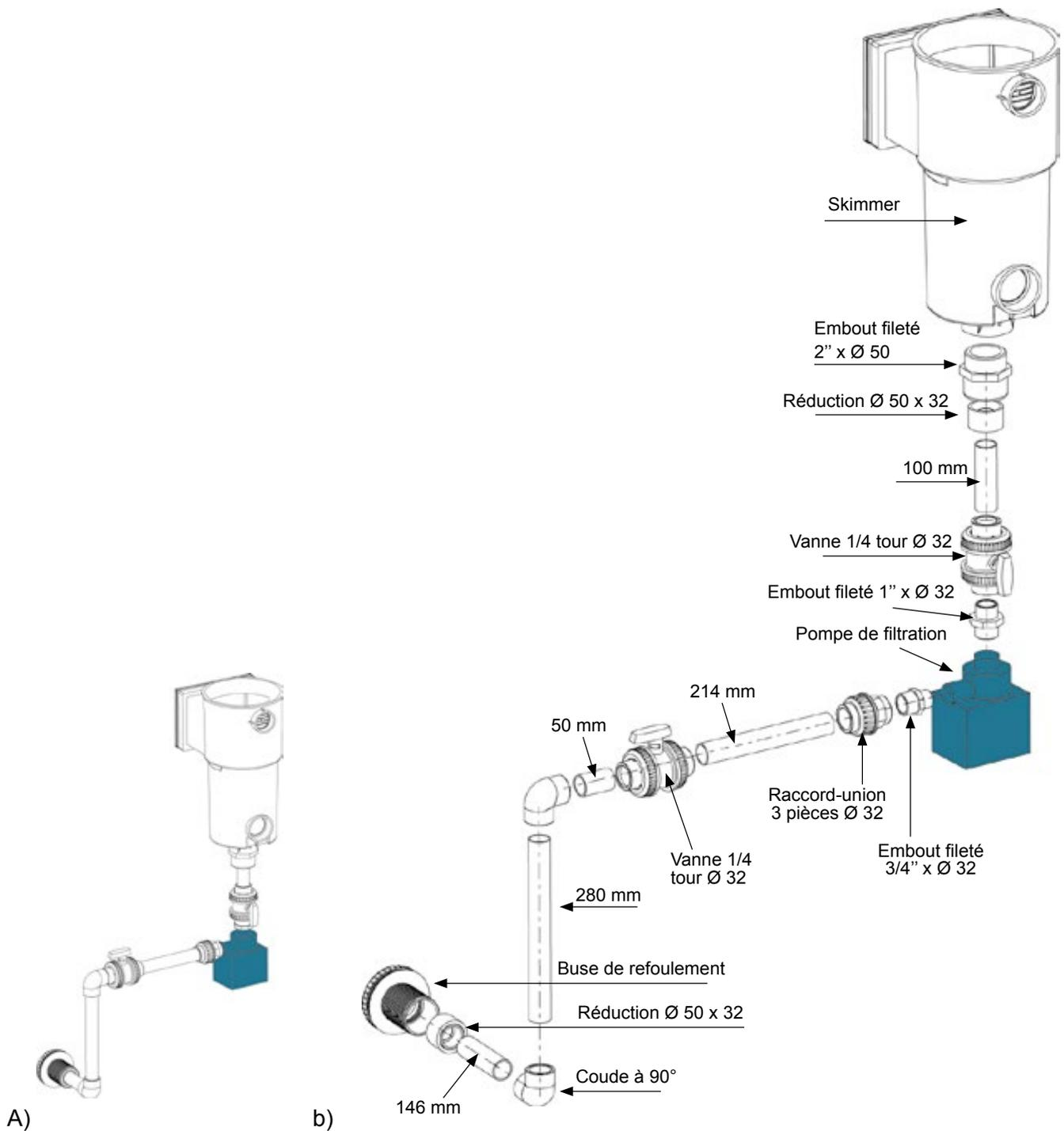
Figure 25 – A et b tuyauterie pour la filtration
