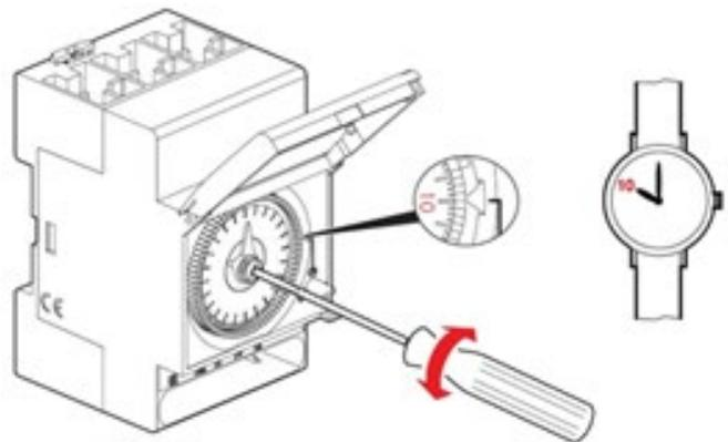
Figure 57 – Réglage de l'heure sur l'horloge de filtration
