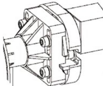
Figure 40 – Montage de l'axe sur le support de palier
