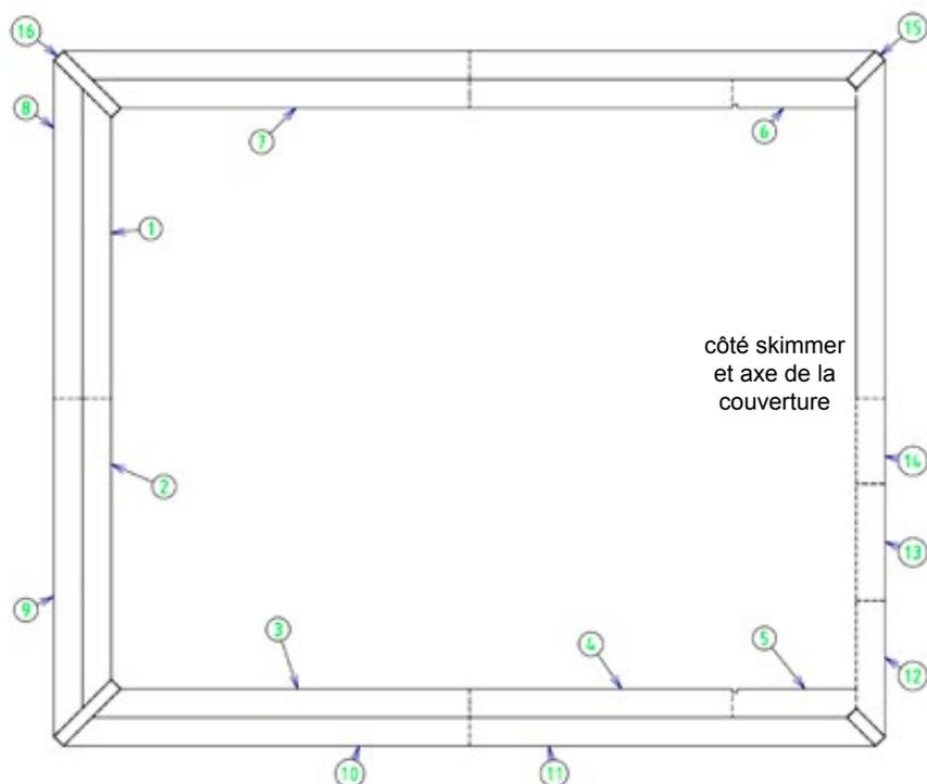
Figure 50 – Disposition des modules de margelles
