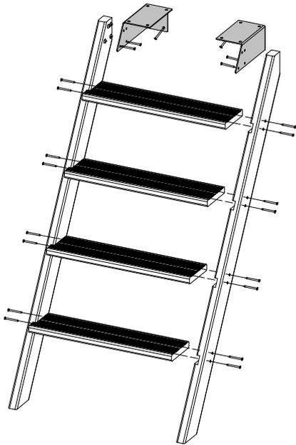
Figure 16 – Montage de l'escalier extérieur en bois
