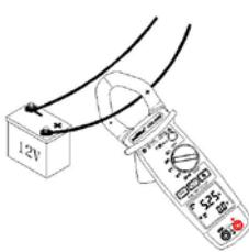
Posizionare il commutatore su  $\text{A} \frac{\text{--}}{\text{--}}$ .
