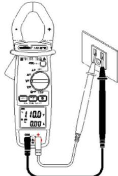
Collegare il cavo di misura rosso sul morsetto "+" ed il cavo di misura nero sul morsetto "COM".
