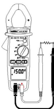
Posizionare il commutatore su  $\Omega \frac{\text{--}}{\text{--}}$ .
