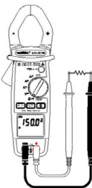
Posicionar el comutador en  $\Omega^{20\Omega}$ .
