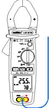
Para la medida de temperatura, conectar la sonda termopar tipo K a los bornes de entrada respetando la polaridad.
