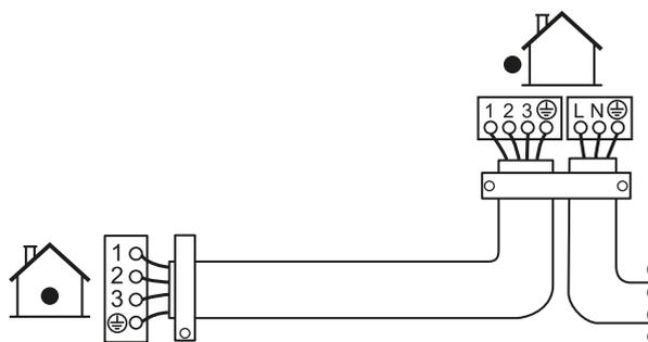
8.2.6 Pour se connecter à un système HA (contrôleur à distance filaire, contrôleur à distance centralisé, adaptateur filaire, etc.)
