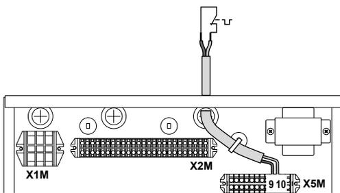
2 Fixez le câble avec les attaches sur les supports d'attaches.
