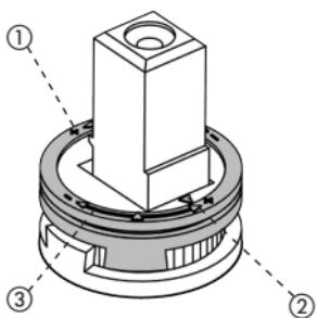
(1) Bague de réglage / Index ring / Einstellring / Pierścień regulujący / Begrenzungsring / Tope de temperatura / Limitador de temperatura / Регулирующее кольцо.
