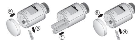
Un calibrage automatique est déclenché après chaque changement des piles. Si l'affichage reste bloqué sur □□□, appuyez 3 secondes sur la touche pour lancer le calibrage automatique (la TRV 1.0 doit être montée sur le radiateur).
