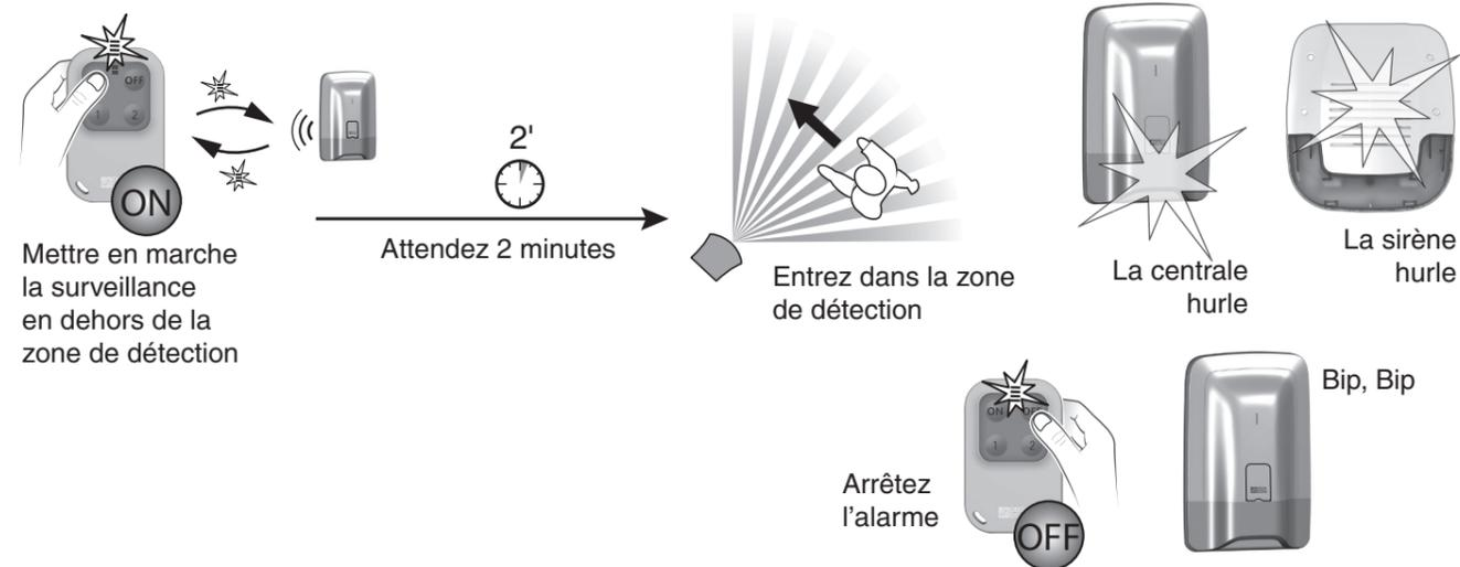
A chaque mise en marche ou arrêt du système, la centrale émet une série de bips, indiquant qu'un événement (ici la détection de mouvement) s'est produit. Vous pouvez le consulter sur un clavier tactile.
