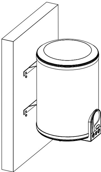
3.- Appuyer le chauffe-eau au mur et le placer sur les fixations.
