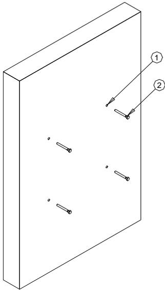
1.- Réaliser sur le mur (1) 4 trous selon les cotes du support et mettre en place les fixations appropriées (2) en fonction du poids du chauffe-eau et du type de mur. Ne pas serrer les fixations avant d'avoir mis en place le chauffe-eau.
