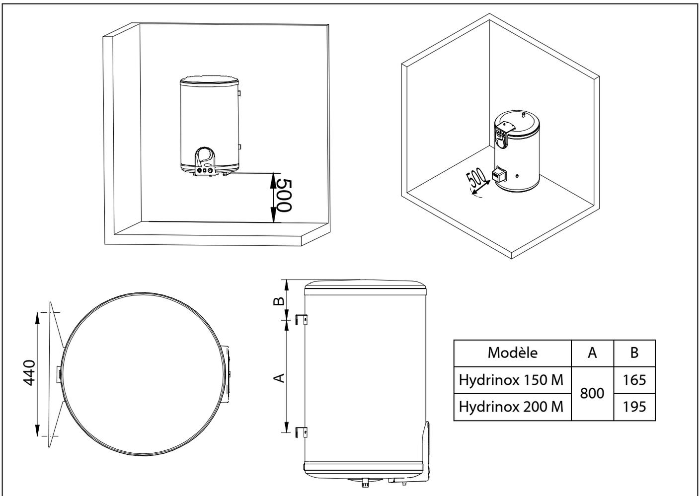
Pour la fixation au mur des modèles **Hydrinox 150 M** et **Hydrinox 200 M**, le chauffe-eau électrique comporte deux supports. Consignes d'installation :
