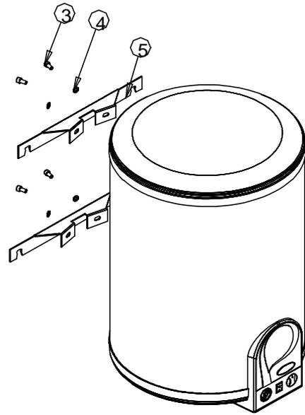
2.- Placer sur le chauffe-eau les supports (5) avec les vis allen (3) et les rondelles (4) jointes.
