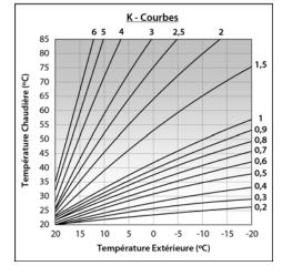
La courbe K optimale pour chaque circuit de chauffage peut varier en fonction du type du circuit, les conditions d'isolement du bâtiment et la position de la sonde. Malgré tout, la recommandation générale est que pour les circuits de chauffage de haut température (p. e. circuit direct aux radiateurs) la courbe K choisie soit égal ou supérieur a 1, et pour circuits de basse température (p.e. circuit mélangé de "plancher chauffant") la courbe K choisie soit égal ou inférieur à 0,8.
