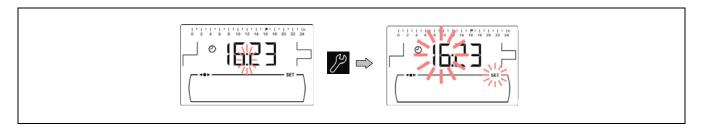
Les symboles "+" ou "-" d'E.C.S. *(19)* permettent de régler la valeur des heures. En appuyant sur  $\mathcal{P}$ , l'heure est sauvegardée et les minutes commencent à clignoter pour les régler également.
