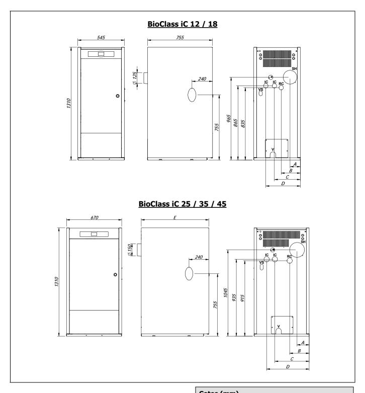
IC : Départ chauffage. RC : Retour chauffage. SH : Sortie de fumée.
