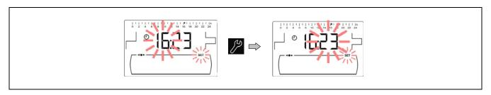
Les symboles "+" ou "-" d'E.C.S. *(19)* permettent de régler la valeur des minutes. En appuyant sur *[P]*, l'heure est sauvegardée et on retourne au *Menu Configuration*".
