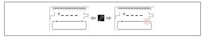
Les symboles "+" ou "-" de Chauffage (18) permettent de naviguer à travers les heures de programmation.
