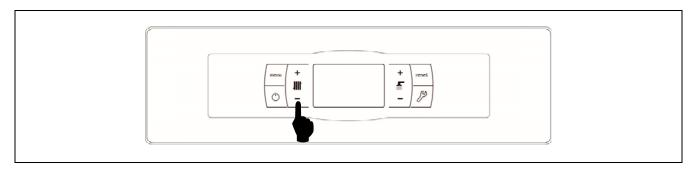
La sélection de température souhaitée du ballon tampon est réalisée à l'aide du sélecteur tactile indiqué sur le schéma. Pour sélectionner la température souhaitée, appuyer respectivement sur les symboles "+" ou "- " afin d'augmenter ou de diminuer la valeur de la température. Après avoir sélectionné la température, un retour à l'écran de repos interviendra après quelques secondes. La plage de température de consigne sélectionnable est de : OFF, 30 - 80°C.
