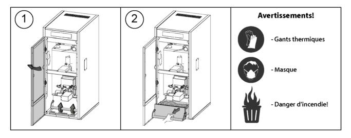
L'utilisateur doit s'assurer régulièrement du bon vidage du cendrier, et vérifier à l'écran de la chaudière son niveau de remplissage.
