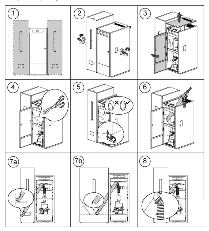
IMPORTANT: S'assurer que les orifices ovales latéraux de la chaudière et du réservoir d'alimention soient à la même hauteur pour pouvoir introduire correctement le vis d'alimentation. Pour cela, effectuer les réglages nécessaires, tant en hauteur (avec les pieds réglables) qu'en profondeur (en situant correctement le réservoir d'alimention).
