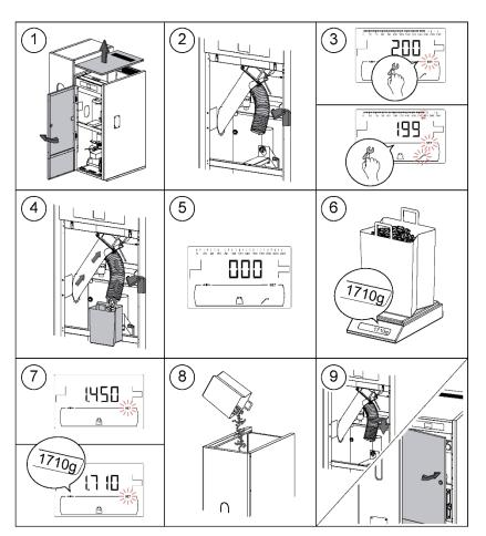
IMPORTANT : Le calibrage doit être effectué avant la première mise en service de la chaudière.
