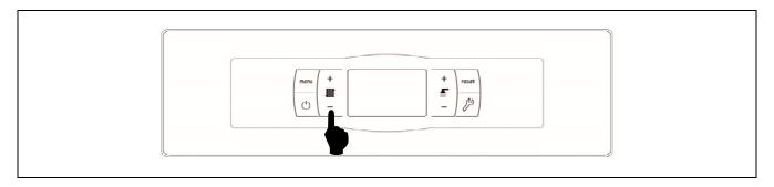
La sélection de température souhaitée de la chaudière est réalisée à l'aide du sélecteur tactile indiqué sur le schéma. Pour sélectionner la température souhaitée, appuyer respectivement sur les symboles "+" ou "-" afin d'augmenter ou de diminuer la valeur de la température. Après avoir sélectionné la température, un retour à l'écran de repos interviendra après quelques secondes. La plage de température de consigne sélectionnable est de : OFF, 30 - 80°C.
