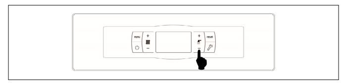
La sélection de température souhaitée de l'ECS est réalisée à l'aide du sélecteur tactile indiqué sur le schéma. Pour sélectionner la température souhaitée, appuyer respectivement sur les symboles "+" ou "-" afin d'augmenter ou de diminuer la valeur de la température. Après avoir sélectionné la température, un retour à l'écran de repos interviendra après quelques secondes. La plage de température de consigne sélectionnable est de : OFF, 15 - 65°C.
