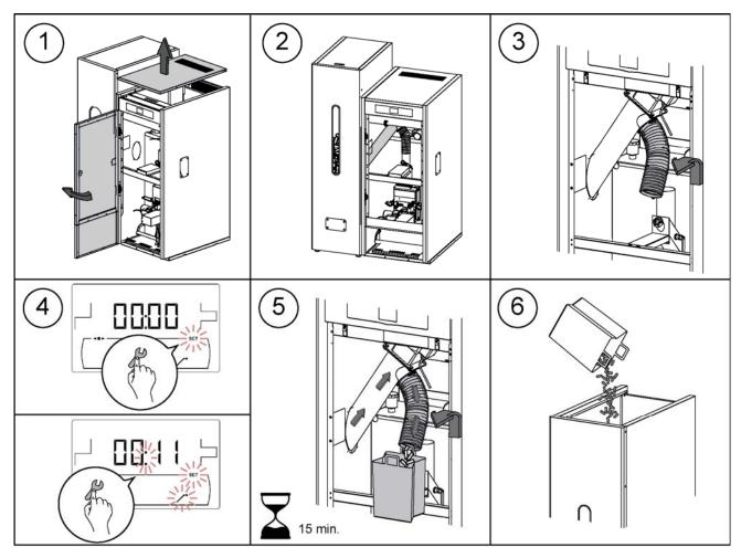
IMPORTANT: Il est strictement nécessaire de procéder au remplissage de la vis d'alimentation.
