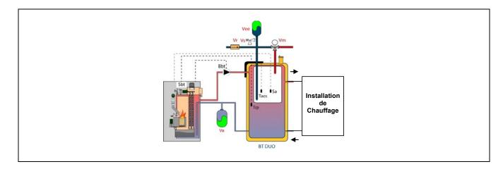
Après avoir réalisé l'installation hydraulique de tous les composants de l'installation, pour réaliser correctement la connexion électrique du ballon tampon BT-DUO avec la chaudière **BioClass iC** il faut procéder de la manière suivante :
