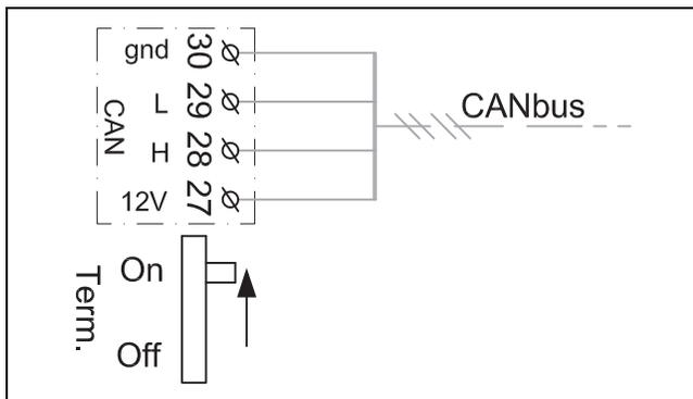
Fig. 16 Terminaison CAN-BUS
