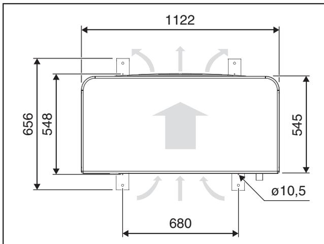
Fig. 6 Dimensions des modèles de pompe à chaleur 13 OR-T-17 OR-T, vue du dessus
