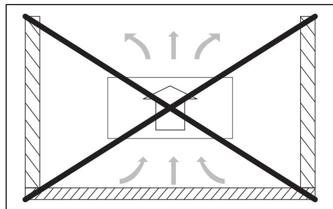
Fig. 8 Éviter d'installer les pompes à chaleur dans des emplacements entourés de murs
