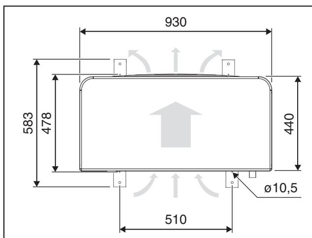
Fig. 4 Dimensions des modèles de pompe à chaleur 5 OR-S-9 OR-S, vue du dessus
