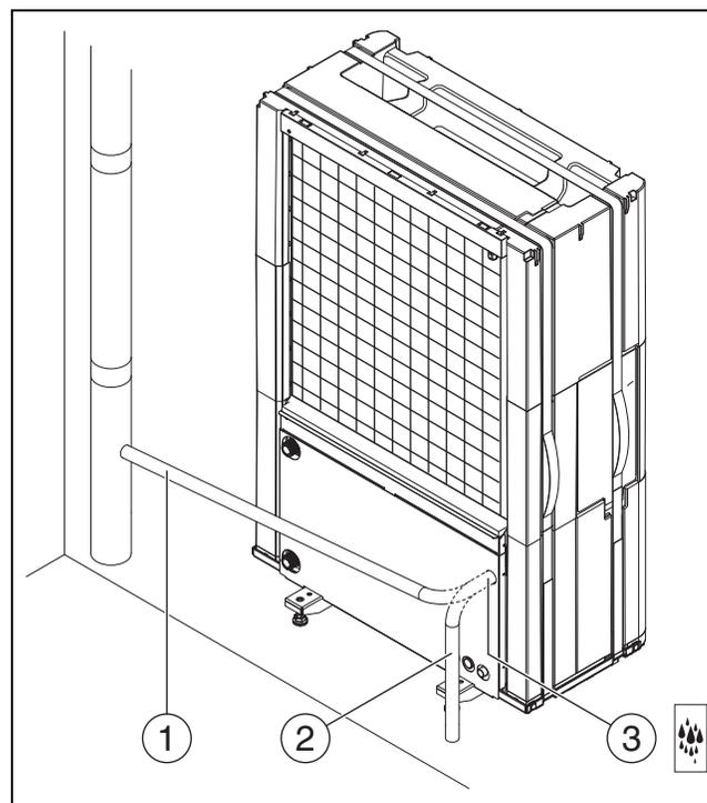
Fig. 14 Raccordements de tube de condensats, valable pour toutes les tailles
