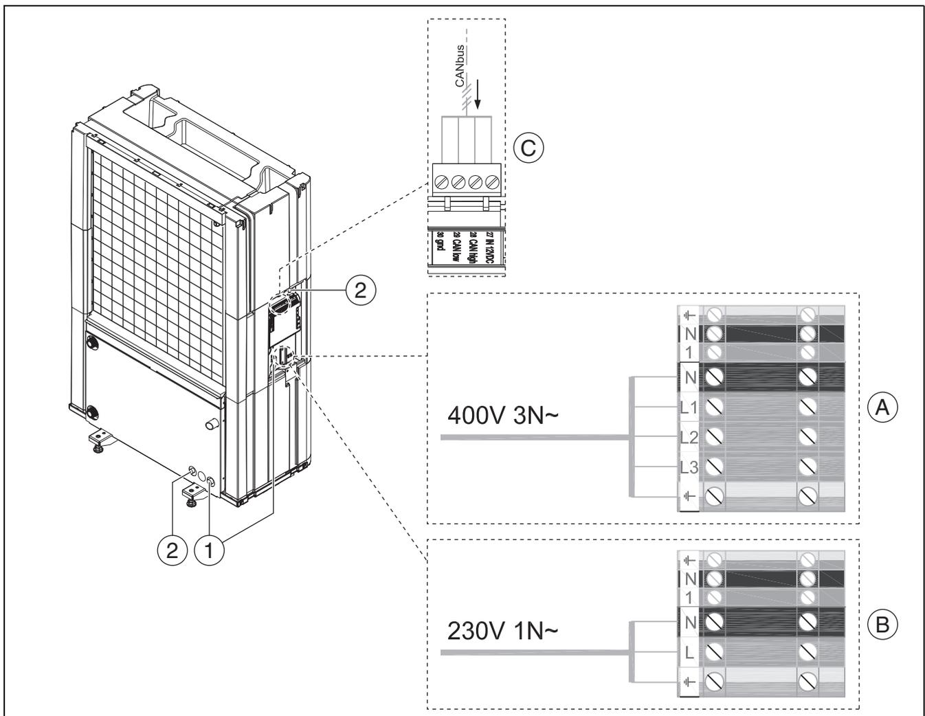
Fig. 17 Chemins de câbles et appareil de commande
