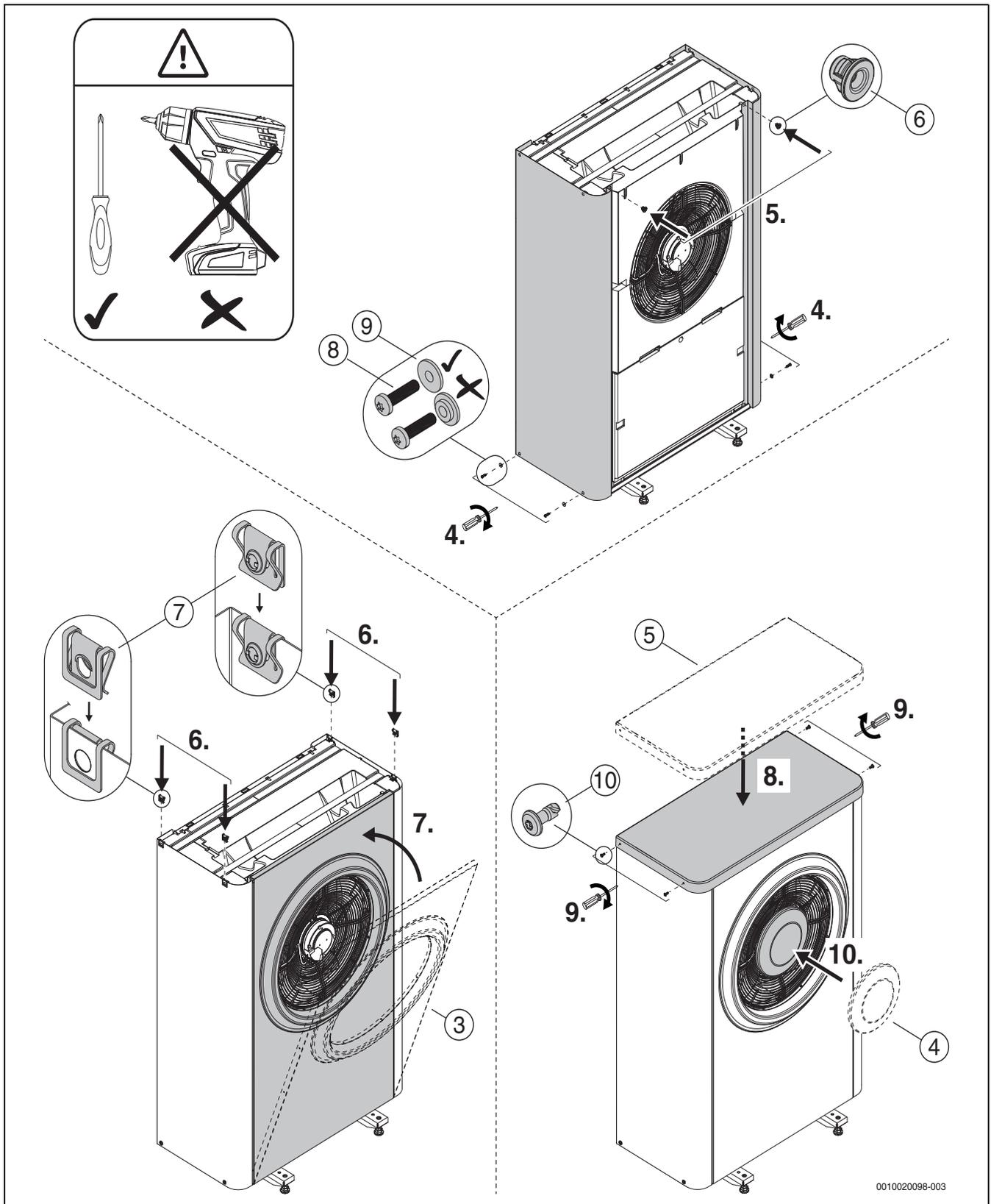
Fig. 19 Monter le couvercle et tôles latérales
