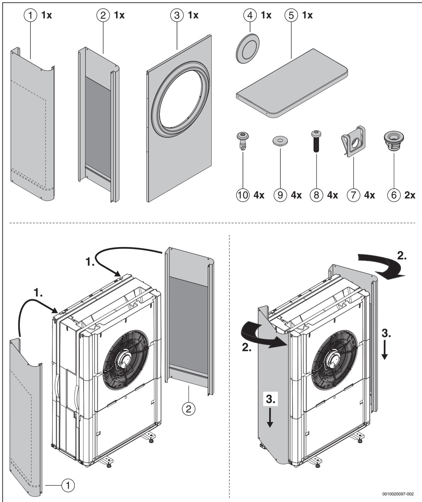
Fig. 18 Monter le couvercle et tôles latérales
