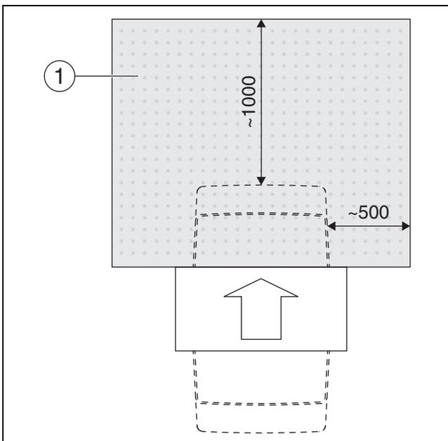
Fig. 10 **DANGER !** Formation de glace devant les pompes à chaleur avec dispositif antibruit (accessoire)
