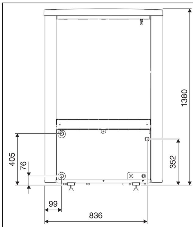
Fig. 3 Dimensions et raccordements des modèles de pompe à chaleur 5 OR-S-9 OR-S, partie arrière
