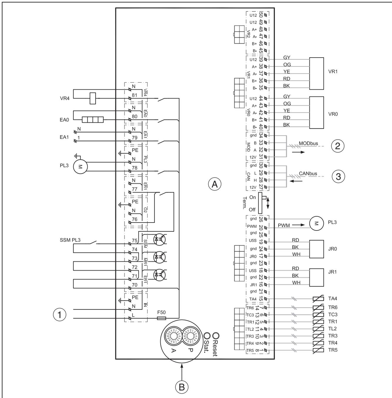
Fig. 23 Schéma de connexion pour module I/O
