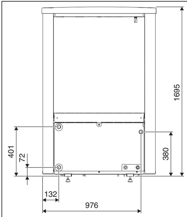
Fig. 5 Dimensions et raccordements des modèles de pompe à chaleur 13 OR-T-17 OR-T, partie arrière
