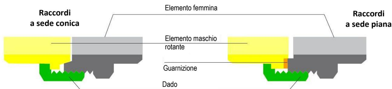
La tenuta detta metallo su metallo è ottenuta mettendo i pezzi direttamente a contatto tra loro. Le parti in contatto sono coniche e vengono realizzate con due angoli diversi in modo da evitare che si blocchino.
