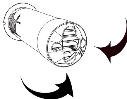
Retourner le joint vers l'intérieur du tube et pousser l'ensemble grille et joint à l'intérieur du tube.
