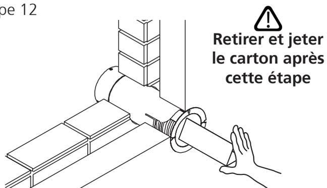
Insérer le carton plié à l'intérieur du conduit et pousser doucement. Le joint doit ressortir du mur et les goupilles doivent s'écarter. Arrêter de pousser quand vous entendez le «click» des goupilles.
