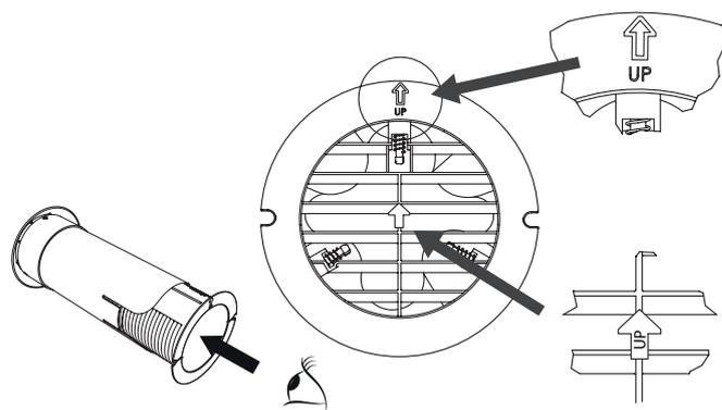
Regarder à l'intérieur du conduit et vérifier que les 2 flèches soient orientées vers le haut et alignées.
