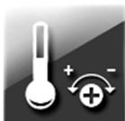
L'indication de température de la sonde d'ambiance peut-être corrigée. La sonde de température est située dans l'interface de contrôle. La valeur de correction peut être introduite avec une précision de 0,1°C.
