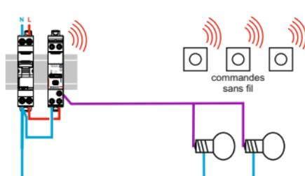
\* : Témoins lumineux non fonctionnels sur poussoirs à voyants avec télérupteur connecté
