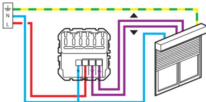
L'interrupteur pour volet roulant est compatible avec les volets roulants à butée mécanique ou électronique, contrôlés par un interrupteur
