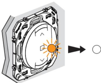
Le voyant de l'**interrupteur pour volet roulant câblé** fourni dans le pack s'éteint.
