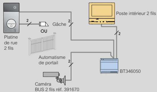
1 : Installation avec une commande d'ouverture
