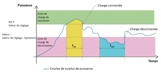
SEt P (en kW): Représente la valeur minimum de surplus sur laquelle nous voulons connecter une charge.
