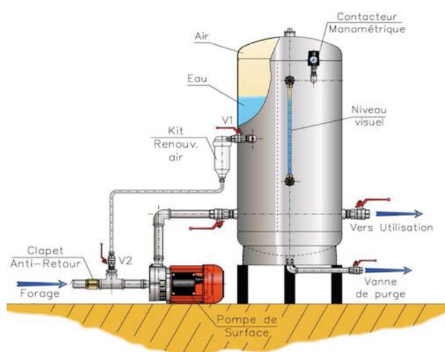
Le Kit de renouvellement d'air doit être installé selon le schéma présenté à gauche. Il convient de choisir le modèle de kit adapté au volume du réservoir (voir le tableau accessoires).
