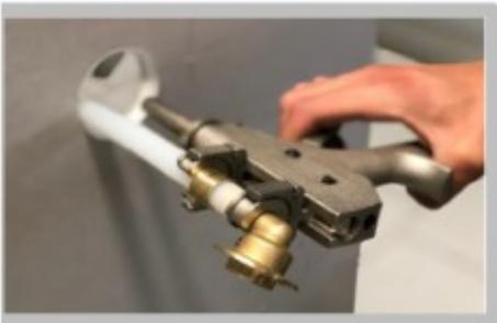
Procéder au glissement de la bague Laiton en prenant soin d'utiliser les outils indiqués dans la fiche technique
