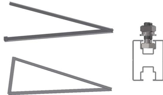
2. Placer le rail de suspension et le pré-verrouiller avec des boulons M8 \* 20, préinstaller deux boulons M8 \* 20 sur le rail de suspension (pour l'installation de l'onduleur), répéter l'étape 1 pour installer une autre partie de la structure du trépied en fonction de l'espacement des trous de la carte de la batterie, et utiliser un ruban à mesurer pour mesurer son espacement à l'endroit approprié.
