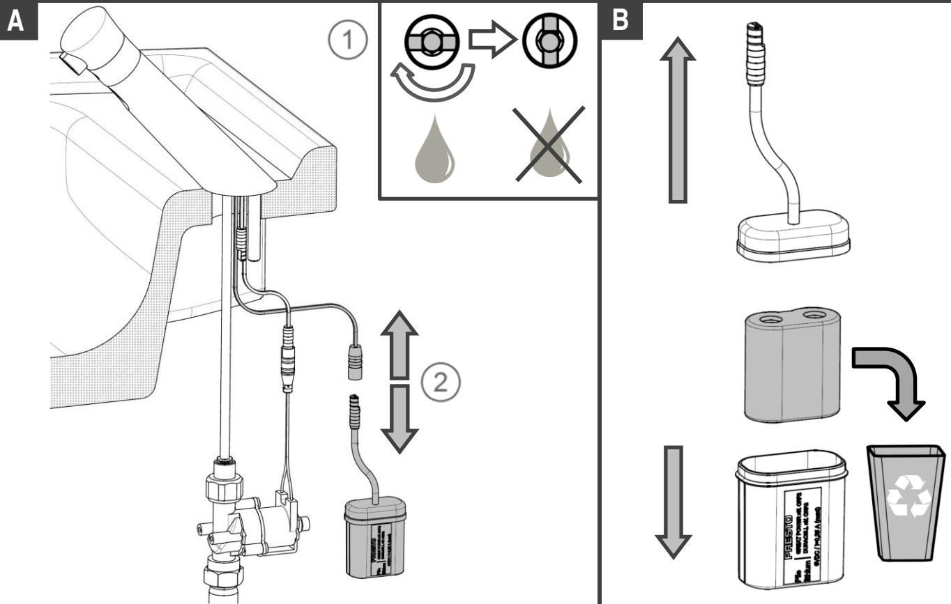
**4-3 Remplacement de l'electrovanne / Replacing the solenoid valve / Auswechseln des Magnetventils / Sustitución de la electroválvula / Sostituzione dell' elettrovalvola / Vervanging van het magneetventiel**
