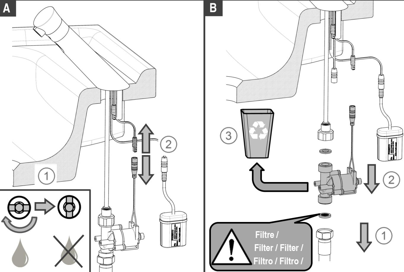
**4-4 Remplacement cellule / Replacing the cell / Auswechseln des Sensors / Sustitución de la célula / Sostituzione della fotocellula / Vervanging van de cel**
