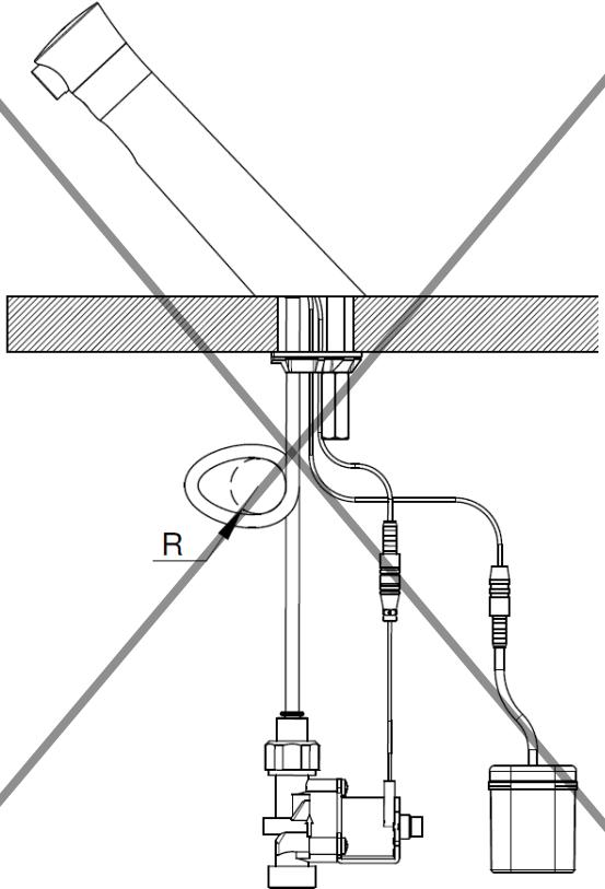
**Si rayon de courbure < Ø25mm recouper le tube avec une pince coupe-tube pour avoir une coupe droite.** / **If bend radius < Ø25mm cut the pipe with a pipe cutter.** / **Wenn Krümmungsradius < Ø25mm das Rohr schneiden um ein gerades Rohr zu bekommen.** / **Si rayo de curvatura < Ø25mm, cortar el tubo con un cortatubos.** / **Quando il raggio è < Ø25mm, tagliare il tubo con una tagliatubi.** / **Als krommingsstraal < Ø25mm, buis met een pijpsnijder doorsnijden.**
