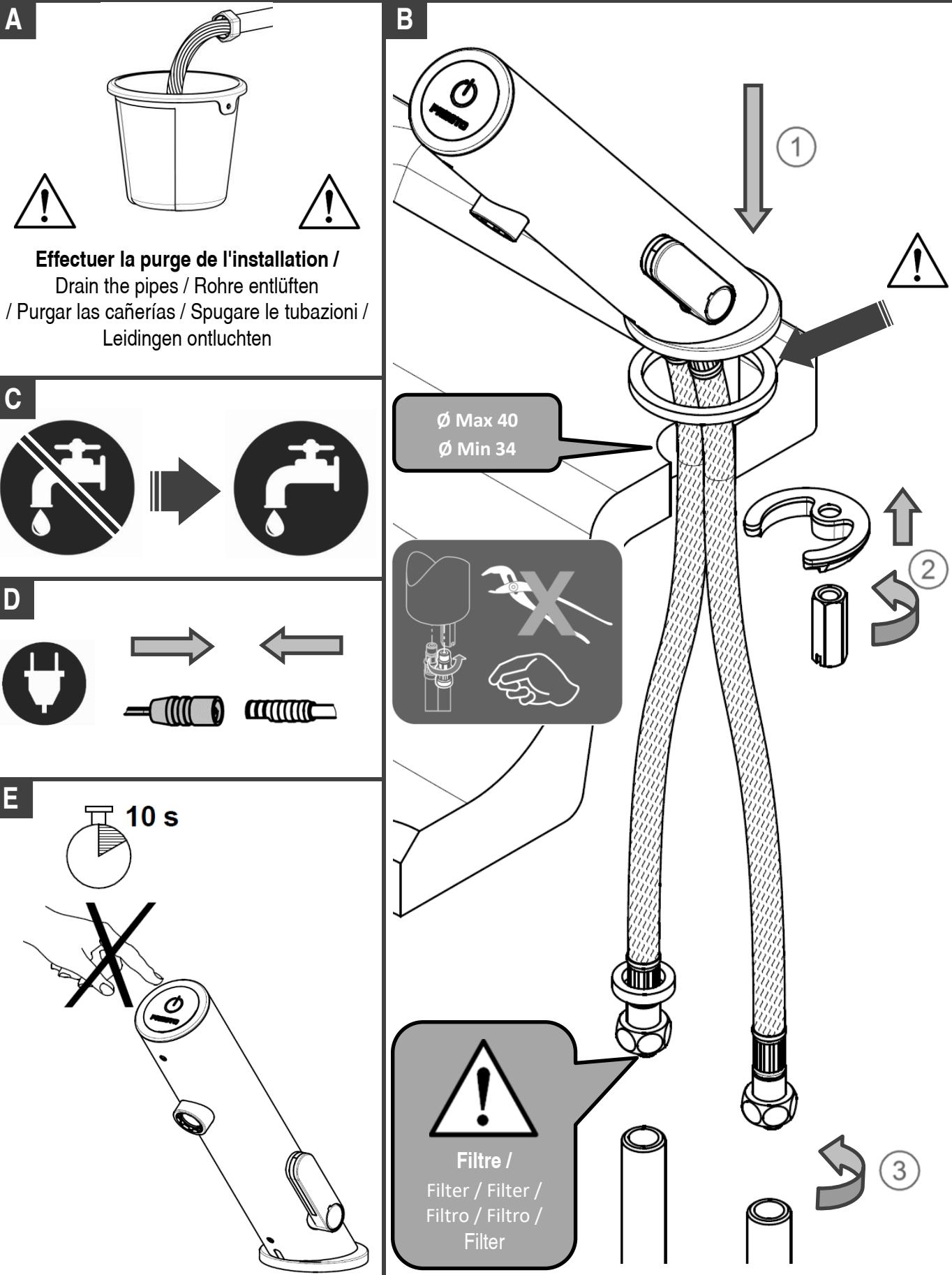
**4-2 Version Simple sur plage / Single deck-mounted tap / Standventil / Grifo sobre repisa / Rubinetto bordo lavabo / Wastafelkraan voor bladmontage**
