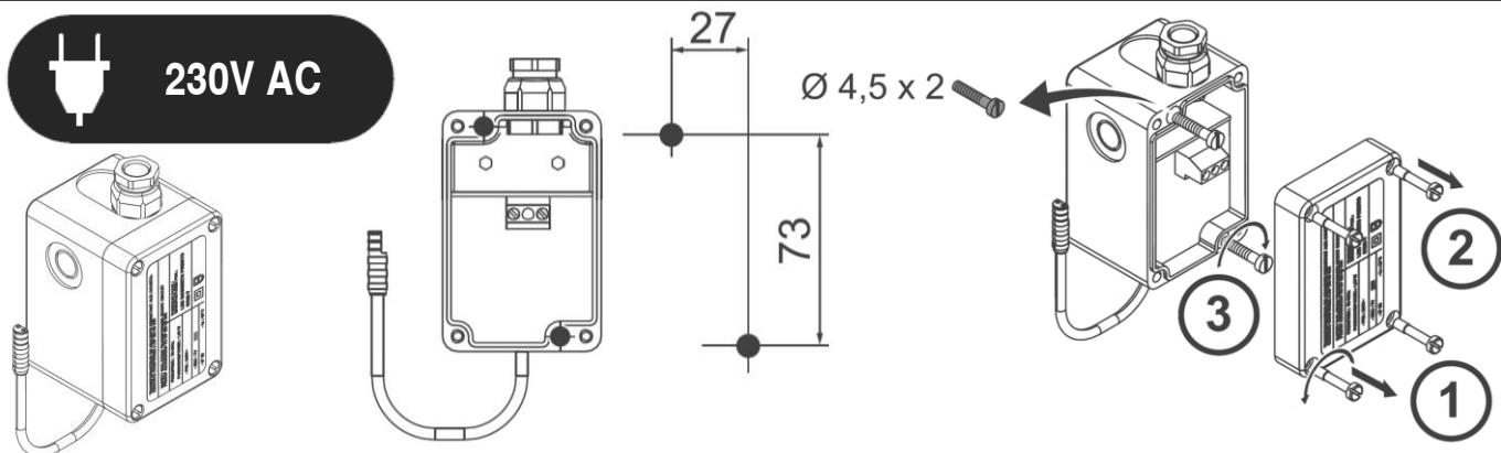
Alimentation 230V/7V - 2,1W par câble 2 x 0,5 mm<sup>2</sup> mini. Débrancher l'alimentation avant toute intervention sur le robinet. Le transformateur est équipé d'une protection thermique contre les surcharges. En cas de déclenchement de celle-ci, il faut couper l'alimentation électrique pendant 30 secondes, résoudre le problème, puis réarmer.
