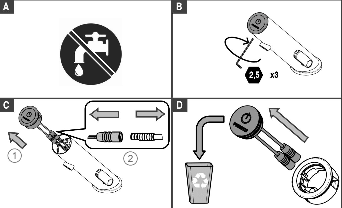
**7-4 Maintenance de l'aérateur / Maintenance of the flow aerator / Wartung Perlator / Mantenimiento del aireador / Manutenzione dell'aeratore / Onderhoud beluchter**
