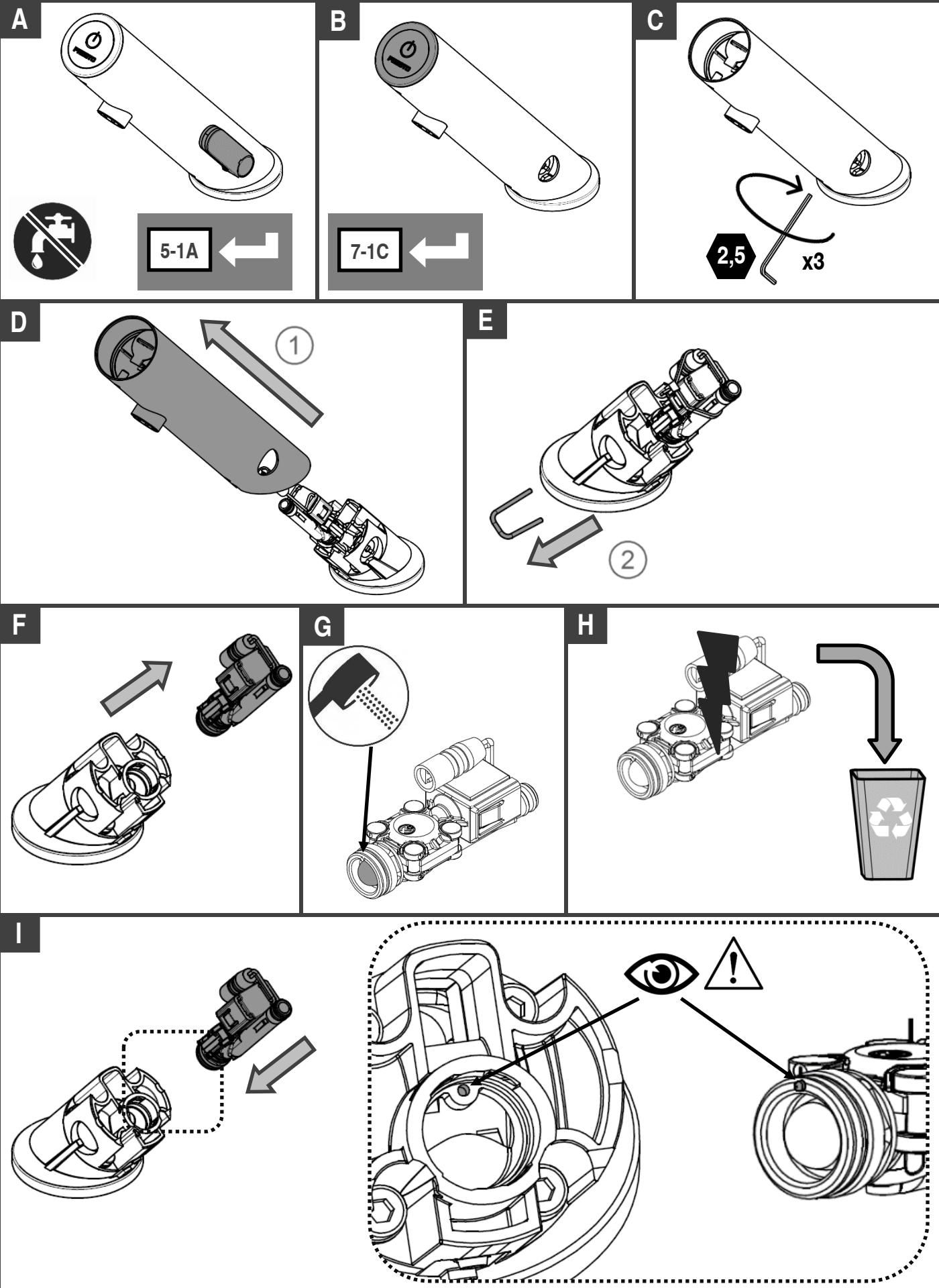
**7-3 Remplacement du bouton de commande / Replacing the control knob / Auswechseln Bedienknopf / Sustitución del botón de control / Sostituzione manopola di controllo / Vervanging van de bedieningsknop**
