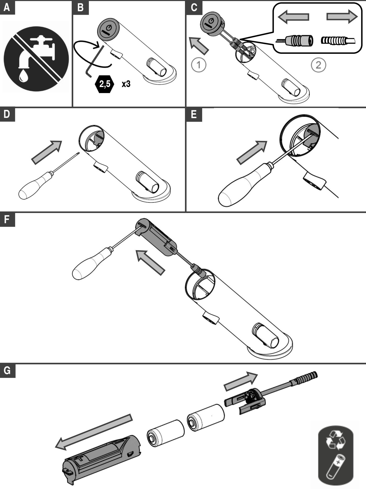
**7-2 Remplacement de l'électrovanne / Replacing the solenoid valve / Auswechseln des Magnetventils / Sustitución de la electroválvula / Sostituzione dell'elettrovalvola / Vervanging van het magneetventiel**
