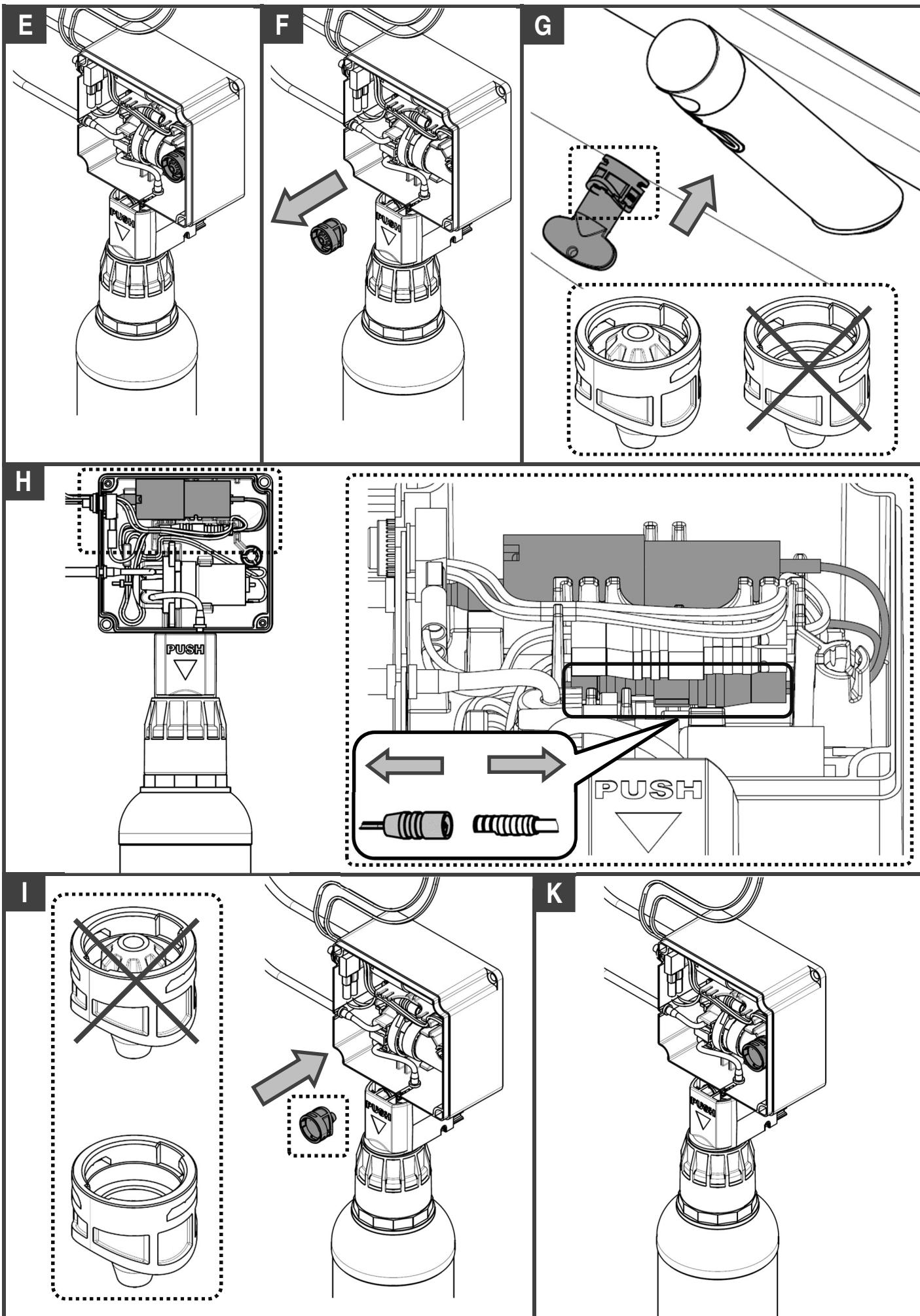
**5-3. Réglage volume délivré / Quantity of soap setting / Mengeneinstellung der Seife / Ajuste del volumen de jabón / Regolazione del volume di sapone / Instellen van de hoeveelheid zeep**
