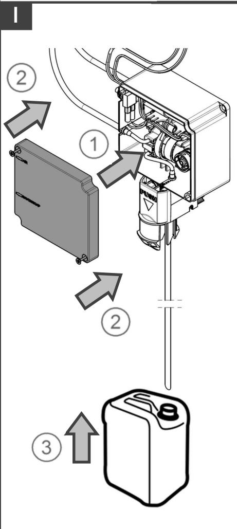
**8-3 Remplacement de la pompe savon / Replacing the soap pump / Seifenspumpe auswechseln / Sustitución de la bomba de jabón / Sostituzione della pompa sapone / Zeppomp vervangen**
