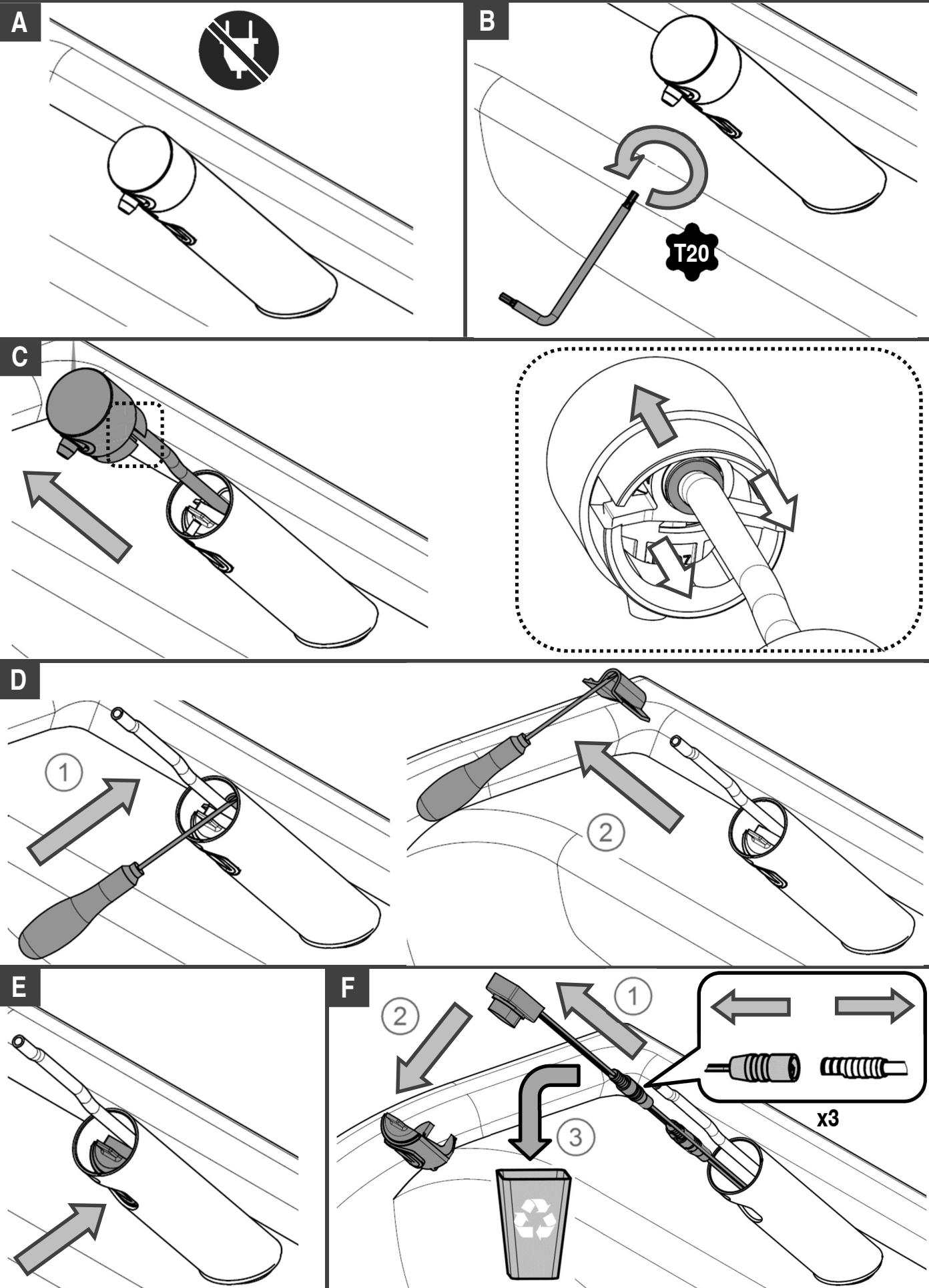
**8-5 Remplacement de la buse / Replacing the spout / Mundstück auswechseln/ Sustitución de la boca / Sostituzione dell'ugello / Vervanging van mondstuk**
