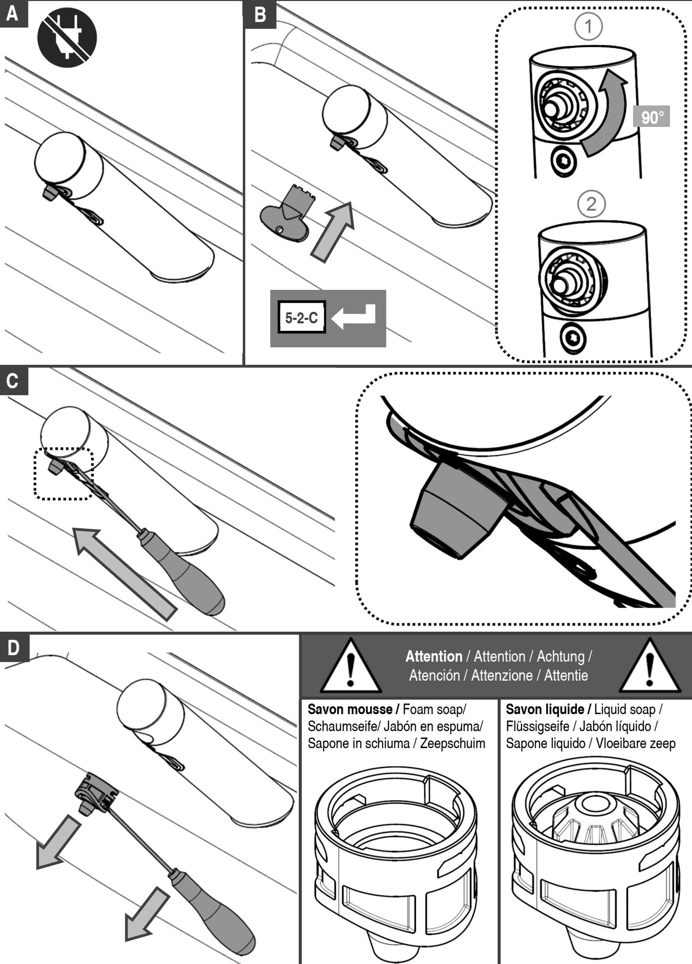
**8-6 Remplacement de la pompe à air / Replacing the air pump / Luftpumpe auswechseln / Sustitución de la bomba de aire / Sostituzione della pompa aria / Vervanging van de luchtpomp**
