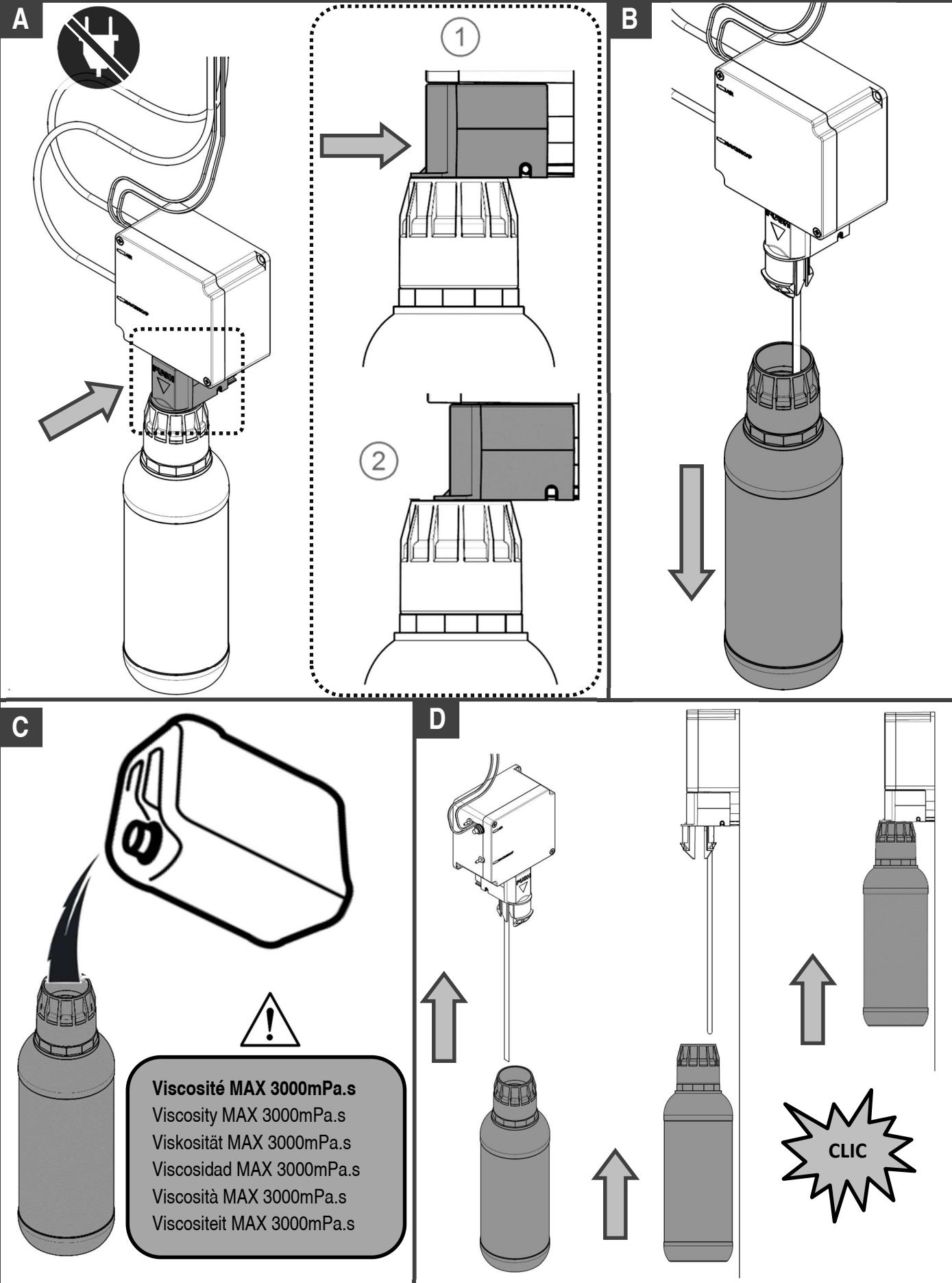
**8-2 Remplacement du tube / Replacing the tube / Rohr auswechseln / Sustitución del tubo / Sostituzione del tubo / Buis vervangen**
