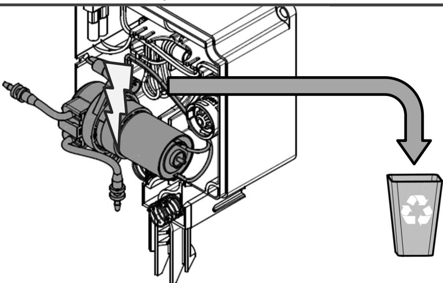
**8-4 Remplacement de la cellule / Replacing the cell / Auswechseln des Sensors / Sustitución de la célula /
