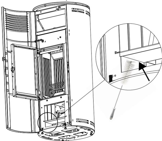
Procéder ensuite au démontage de la calorite supérieure « H » ; pour cela, ouvrir la porte du foyer et, avec les mains, soulever la plaque en calorite « H » vers le haut, l'incliner vers la droite ou la gauche de façon à la faire sortir des supports et l'enlever.
