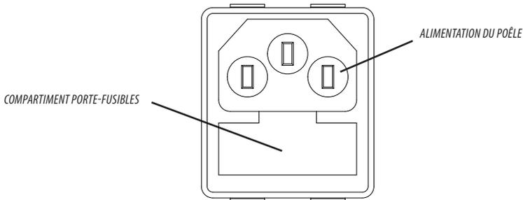
fusibles (5x20 mm T retardé/3, 15 A 250 V) qu'il pourrait être nécessaire de remplacer si le poêle ne s'alimente pas (ex : l'écran du panneau de contrôle ne s'éclaire pas) - opération prise en charge par un technicien autorisé et qualifié.
