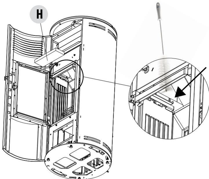
Avec le bec de l'aspirateur, aspirer les cendres et la poussière qui se sont éventuellement accumulées sur l'échangeur (voir la flèche).
