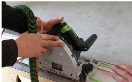
Pour les coupes droites, utiliser un rail de guidage et une scie circulaire plongeante équipée d'une lame pour découper l'aluminium.
