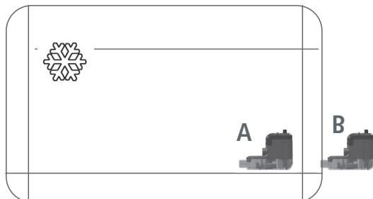
Le bloc pompe peut être fixé à l'intérieur du climatiseur (A), ou à l'extérieur (B).
