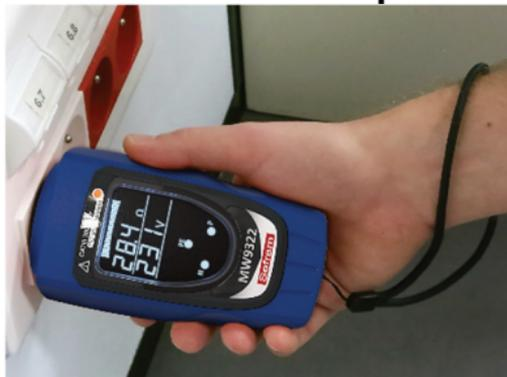
**Observez les indications affichées par MW9322** pour connaître le raccordement de la prise de courant la tension phase-neutre, et l'impédance de la prise de terre de l'installation.
