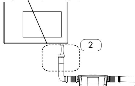
FR Contrôler régulièrement l'état des granules. Le niveau des granules doit rester au-dessus du niveau minimum inscrit sur l'étiquette du produit. Renouveler les granules tous les ans. Lors du changement des granules, nettoyer le neutralisateur.
