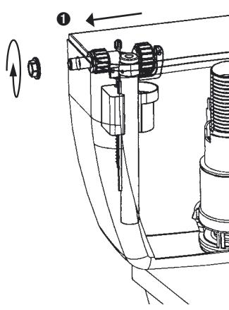
① Positionner le robinet du côté de l'arrivée d'eau et le fixer à l'aide de son écrou
