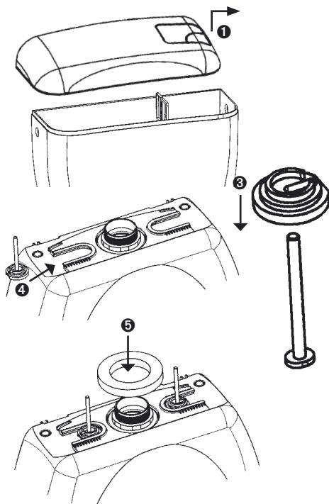
③ Positionner les plaquettes (e) sur les vis (f)
