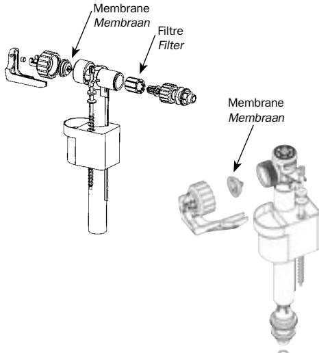
N.B. : Effectuer l'étanchéité du raccordement au réservoir avec le joint fibre ou filtre, à l'exclusion de toute pâte à joint corrosive.
