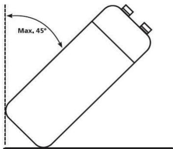
**⚠ ATTENTION : EN RAISON DU CENTRE DE GRAVITÉ ÉLEVÉ ET DU FAIBLE COUPLE DE RENVERSEMENT, LE BALLON DOIT ÊTRE PROTÉGÉE CONTRE LE BASCULEMENT.**
