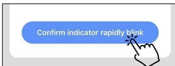
Remarques : lorsque l'icône « SET » clignote rapidement, cela signifie que le contrôleur est en mode Wi-Fi. Lorsqu'il clignote lentement, cela signifie que le contrôleur est en cours de connexion à l'application. Pendant la connexion, si l'icône « SET » s'éteint, cela signifie que la connexion de l'application avec l'unité est terminée.
