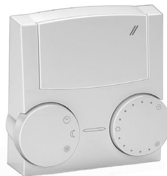
La commande à distance FE 7 permet de modifier la consigne de température ambiante pour le circuit de chauffage de  $\pm 5$  °C ainsi que le mode d'exploitation.
