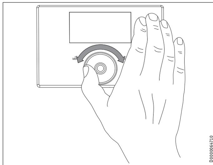
La molette tactile comporte un capteur tactile. Une touche tactile est disposée à gauche et à droite de la molette. La molette tactile et les touches tactiles vous permettent de commander toutes les fonctions nécessaires de l'appareil et de les contrôler.
