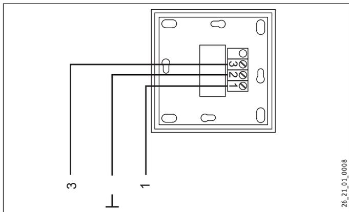
Avec la commande à distance FE 7, vous pouvez modifier la consigne de température ambiante des circuits de chauffage 1 ou 2 de  $\pm 5$  °C seulement en mode automatique. Vous pouvez en outre modifier le mode de fonctionnement. Raccordez la commande à distance aux bornes Fernb.1 et Fernb.3 du bornier XD04 et au bornier de masse très basse tension XE04 de l'appareil.
