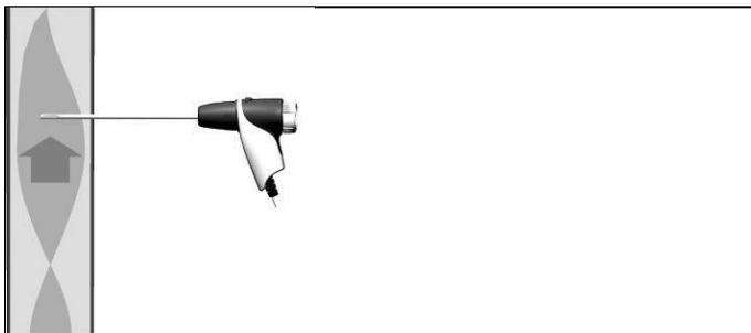
La pointe de la sonde doit se trouver dans le flux central des fumées.
