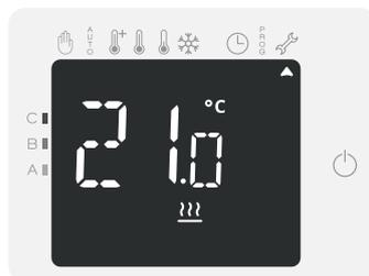
Augmenter de 2°C la température mesurée par la sonde à l'aide de la touche +.
