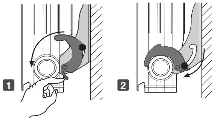
Les sécurités anti-basculement sont en place, le radiateur ne peut plus être décroché du mur sans déverrouillage préalable.
