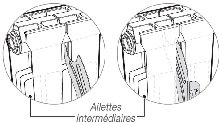
Les pattes de fixation murale sont conçues pour sécuriser l'installation et limiter les mouvements de translation de l'appareil en cas de choc.
